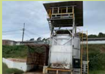
▲集めた豚糞の水分を飛ばす機械
