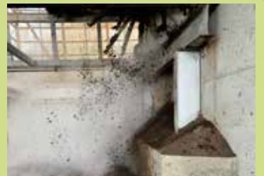
▲攪拌中。発酵熱で湯気発生。
