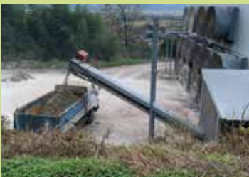
▲鶏舎からベルトコンベアーで鶏糞を搬出▲
